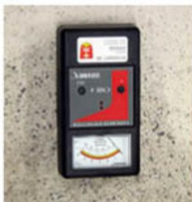
اندازه گیری درصد رطوبت لایه زیرین فوق العاده مهم است. زیرا لایه های زیرین سیمانی معمولاً باید با درصد رطوبت کمتر از  $pbv\% 4%$  پوشش شوند. آزمایش ASTM D4263 از مایشی ساده با ورق پلی اتیلن به مساحت حداقل ۱ مترمربع است که سطح بتون با آن نواربرنده می شود. این سطح بتون باید پیش از برداشت و آزمایش دستکم ۲۴ ساعت به حال خود رها شود. رطوبت سطح هایی مانند
